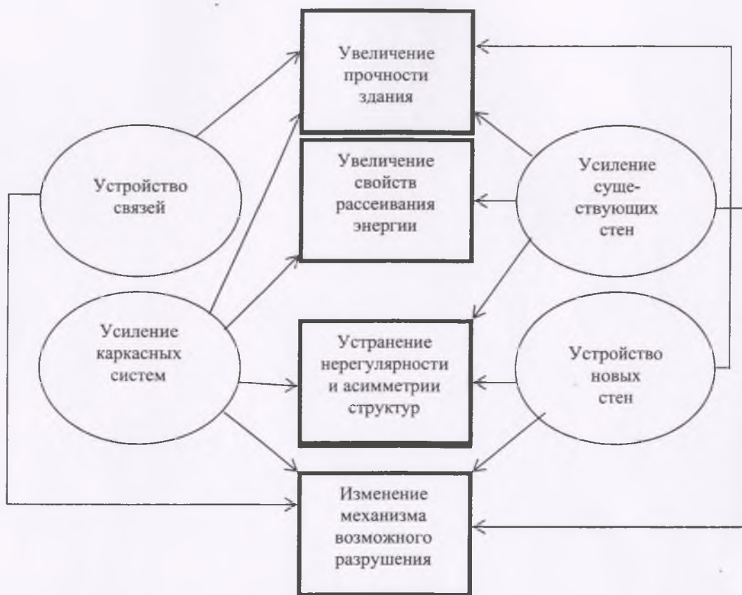
Рис. 1. Стратегия улучшения антисейсмических свойств зданий при реконструкции.
