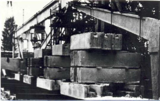
Рис. 1. Випробування рами завантаженням штучними вантажами
