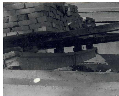
Рис.10.Залізобетонні таврові прогони в процесі випробувань
