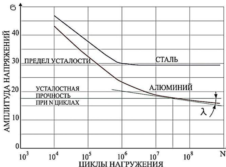
Рис.2.1. Кривые усталости алюминия и стали [21].
