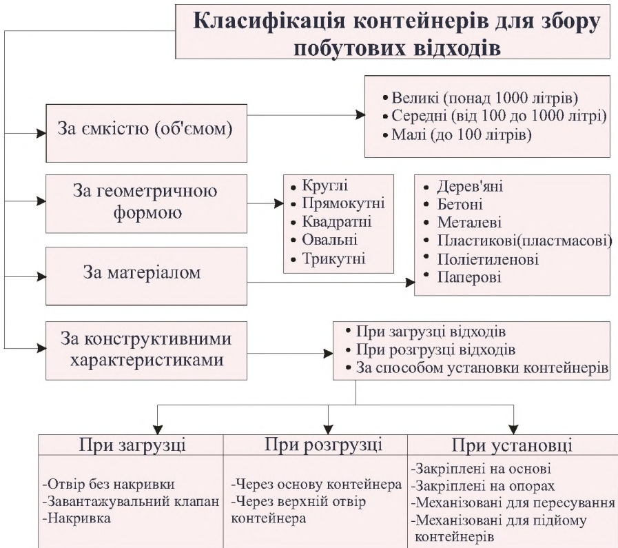
Рис. 3. Класифікація контейнерного обладнання
