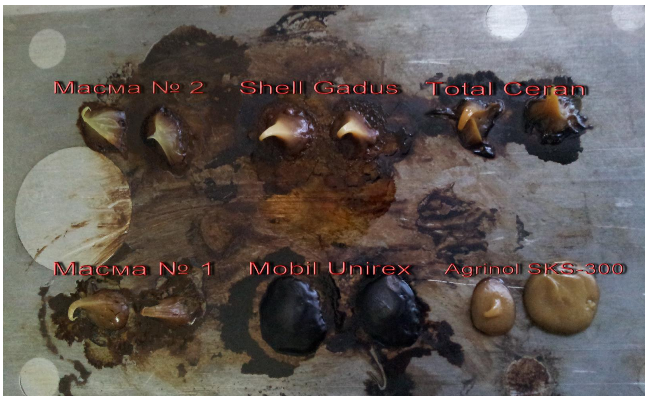
Рис.5.17. Результати випробувань при 300 °С за методом Hot Plate товарних мастил та зразків синтезованих мастил (крайні зліва)
