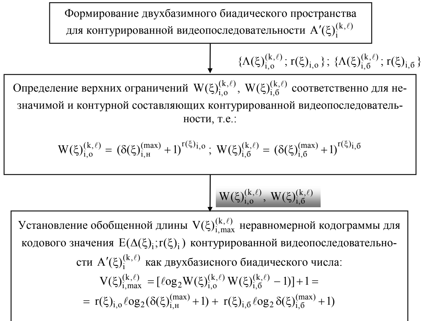
Рис. 5.4. Структурная схема функционала двоичного кодообразования для формирования кодограмм двухбазисных биадических кодовых значений
