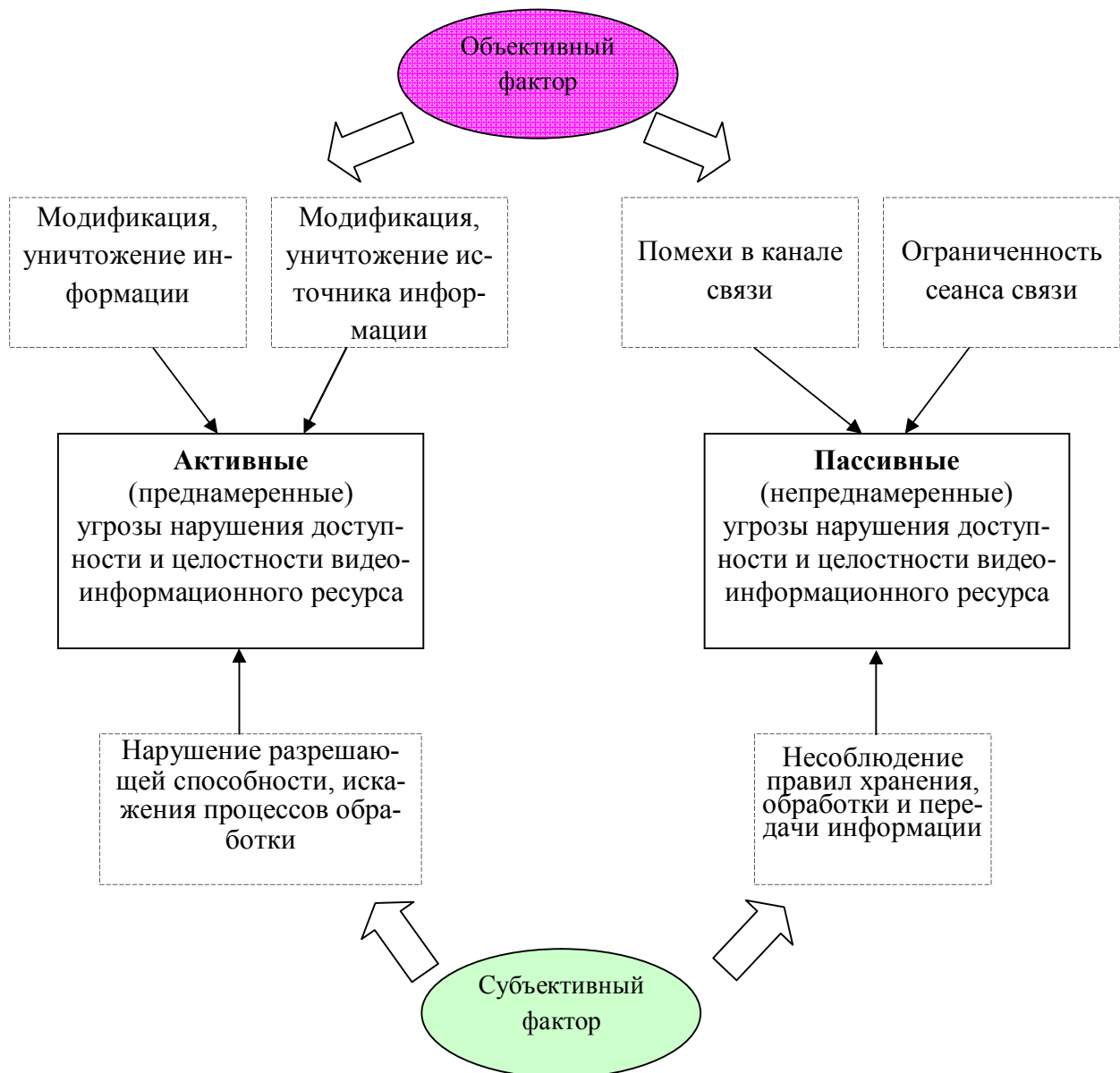
Рис. 1.8. Классификация наиболее значимых угроз нарушению доступности и целостности видеoinформации
