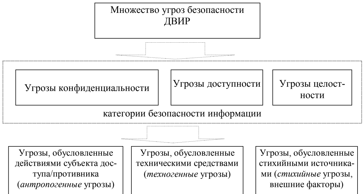
Рис. 1.5. Модель классификации угроз безопасности ДВИР
