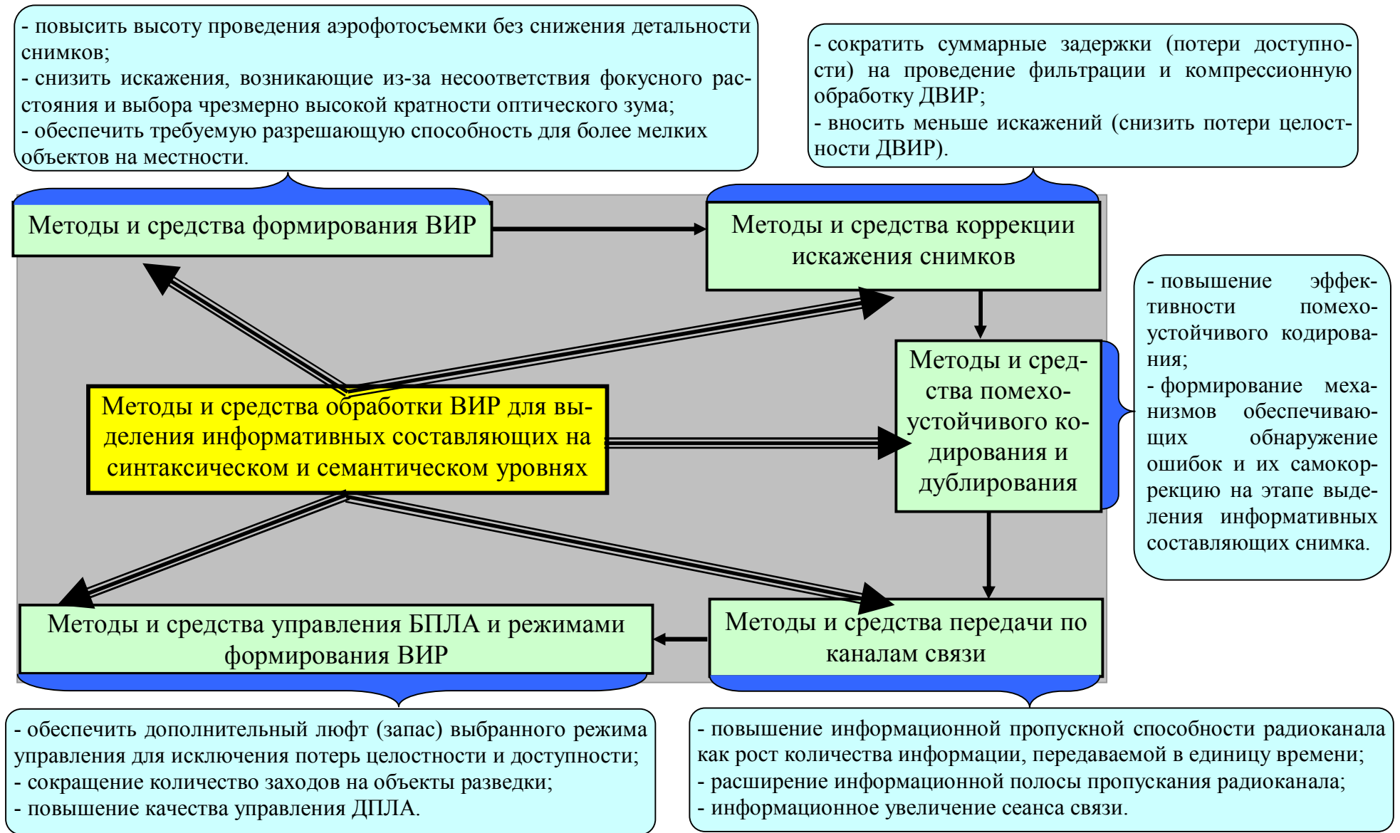
Рис. 2.3. Схема зависимости повышения уровня информационной безопасности от эффективности методов выделения и представления информационных составляющих ДВИР
