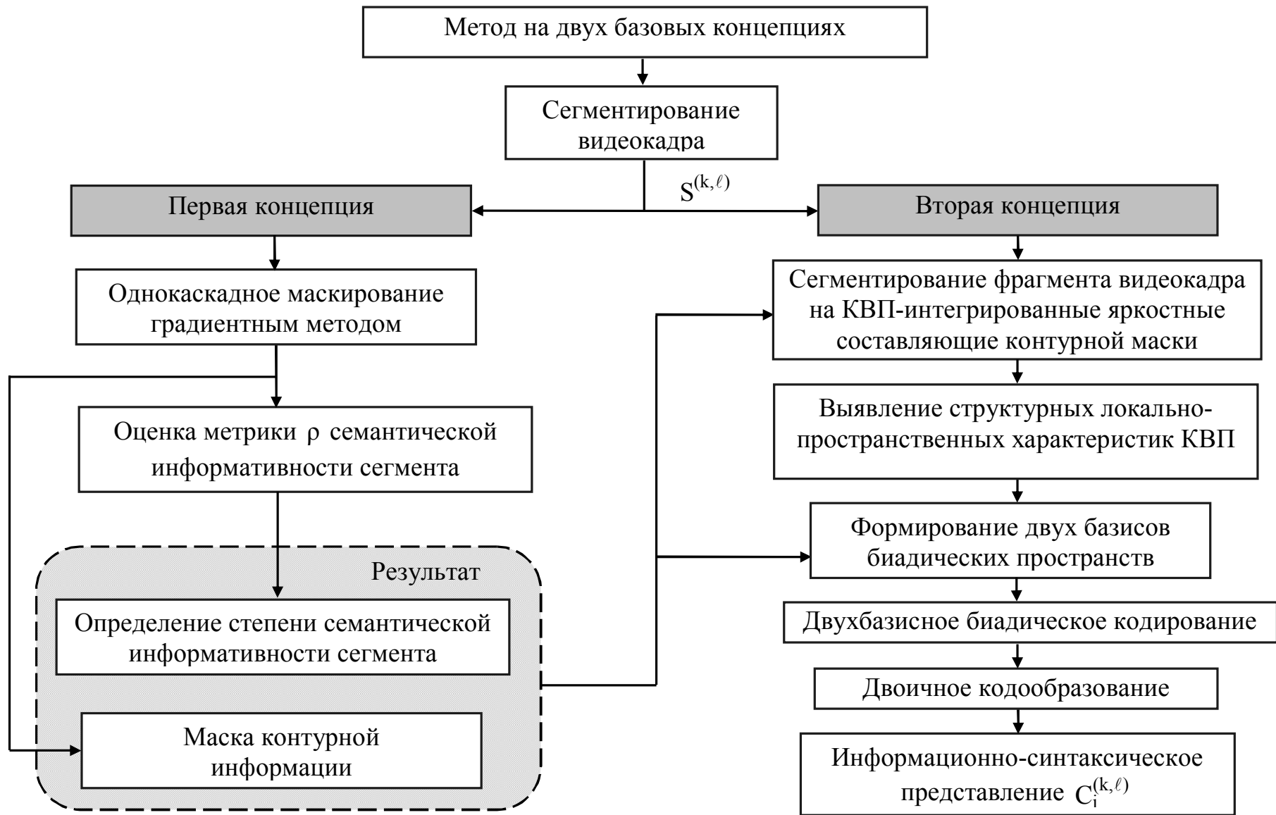
Рис. 5.3. Схема процесса формирования информативного синтаксического представления сегментов видеокадра с учетом концепции оценки семантической информативности
