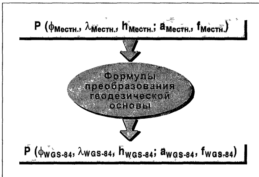
Рис. D-1. Общий принцип преобразования геодезической основы
