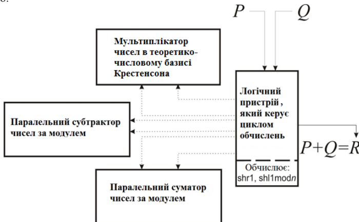
Рис.18. Модель суматора точок на еліптичній кривій
