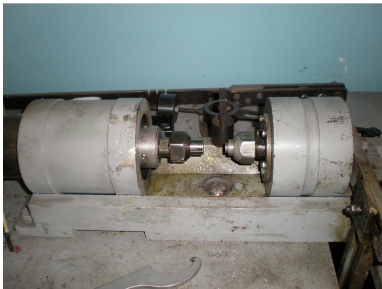
Рисунок 2.16 – Загальний вигляд установки для випробувань в умовах фретинг-зношування
