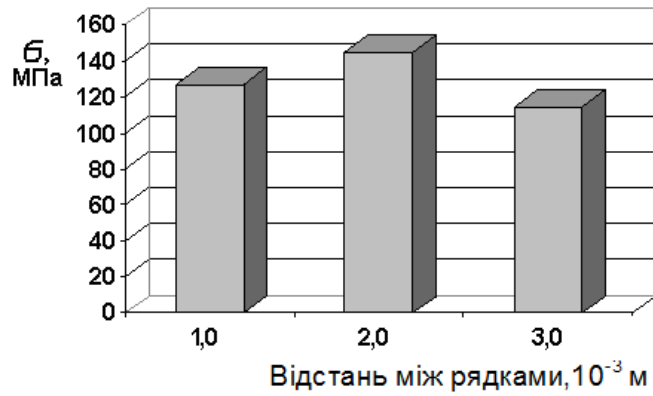
Рисунок 3.4 – Залежність залишкових напружень дискретної поверхні від відстані між рядками (відстань у рядку 2,0 \times 10^{-3} м, глибина ДД 1,5 \times 10^{-3} м)
