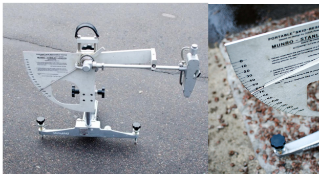
Рис. 8 Портативний маятниковий прилад МП-3
