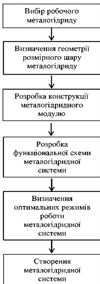
Рис. 1 – Структурна схема розробки металогідридної системи
