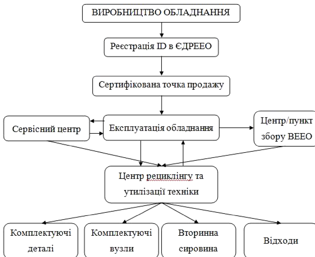
Рис. 1 – Система поводження з електронною складовою муніципальних відходів
