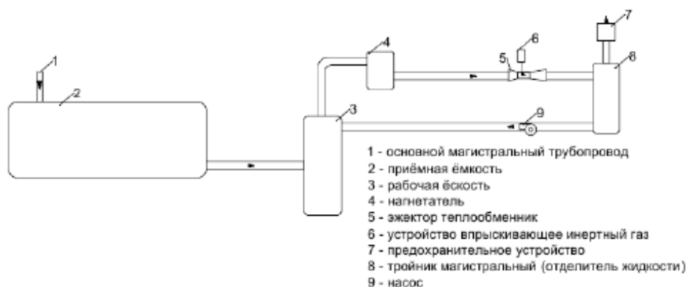
Рис. 2 – Схемное решение для конденсации углеводородов в системе слива/налива из/в ёмкость
