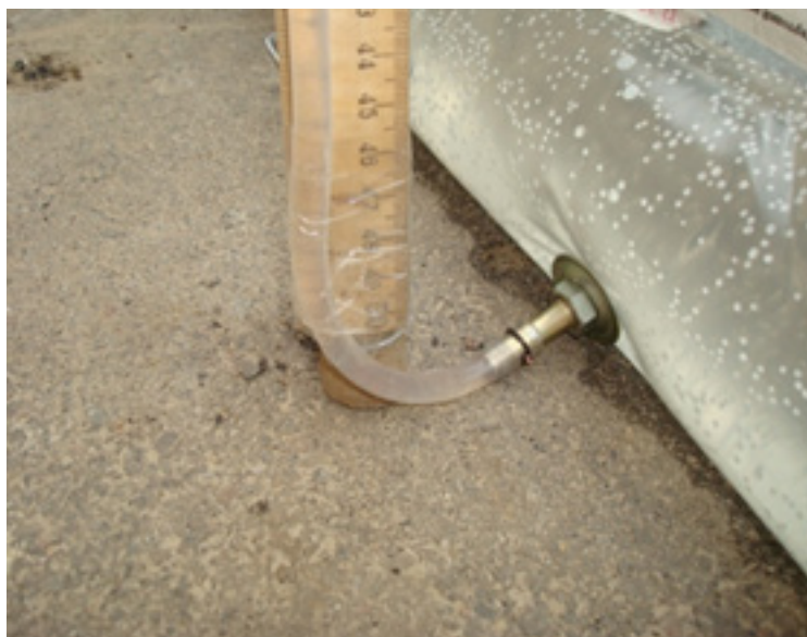
Рис. 4. Приєднання п'езометра до оболонки-рукава і вимірювання напору води в рукаві
