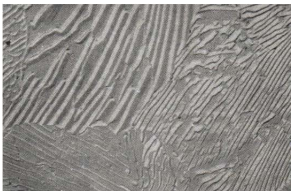
Рисунок 1- Структура продуктов распада аустенита при непрерывном охлаждении (а – мартенсит, x1000); (б- перлит, x1000); (в – сорбит, x5000); (г- троостит, x5000).
