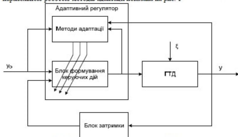
Рис. 1. Структура системи управління ГТД
