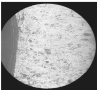
Рис. 2.1. ДР на поверхности сплава Д16АТ у отверстия под заклепку
