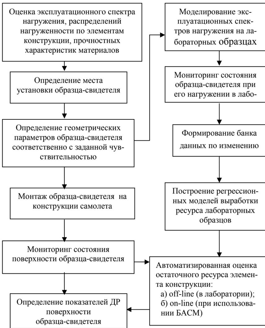
Рис. 3.44. Структурно-логическая схема реализации прогнозирования остаточного ресурса конструкций по параметрам ДР поверхности структурно чувствительных образцов-свидетелей
