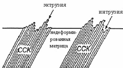
Рис. 1.12. Схема представления полос скольжения, экструзий, интрузий [97]
