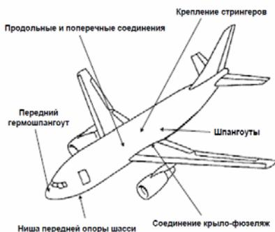
Рис. 4.5. Восприимчивые к MSD критические места конструкции для А300 [1]
