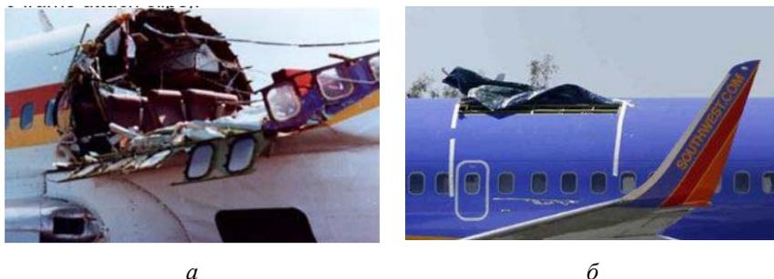
Рис. 4.1. Разрушение обшивки фюзеляжа самолетов Boeing от многоочагового повреждения заклепочных соединений. Авиакомпания Aloha Airlines, рейс 243 (а) и Southwest, рейс 882 (б)
