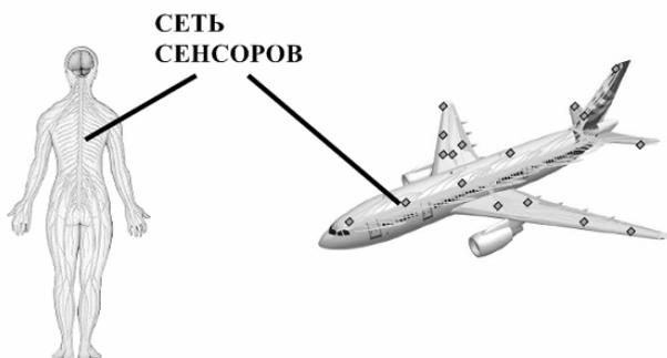
Рис. 1.6. Схематическое представление системы сенсоров в конструкции самолета в виде нервной системы человека [30]
