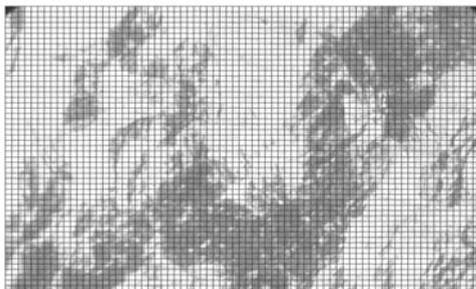
Рис. 2.23. Фотография участка поверхности ( $\times 350$ ) со следами деформационного рельефа (темные участки) с наложением сетки квадратных ячеек
