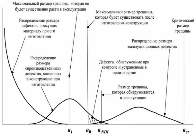
Рис. 1.2. Схематическое представление характерных размеров дефектов в конструкциях при их изготовлении и эксплуатации [9]
