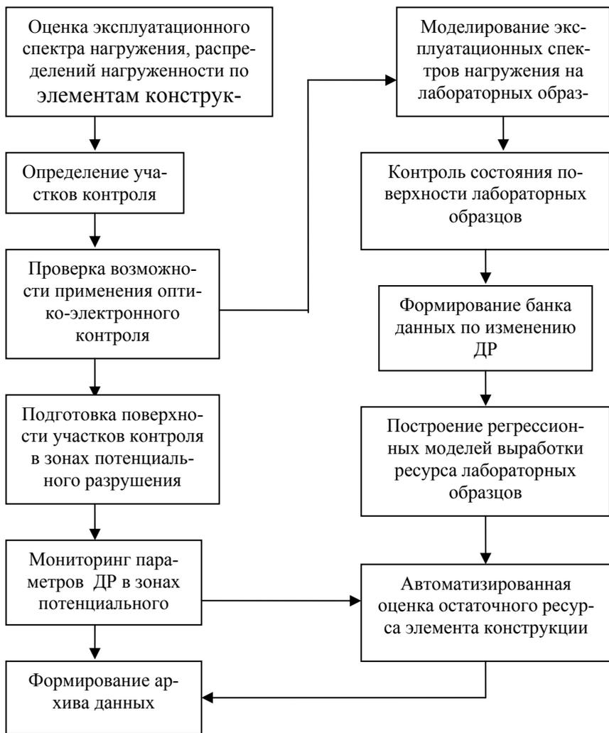
Рис. 3.43. Структурно-логическая схема для реализации прогнозирования остаточного ресурса при непосредственном контроле элементов конструкций
