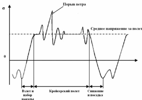
Рис.3.10. Схема нагружения нижней части обшивки крыла самолета
