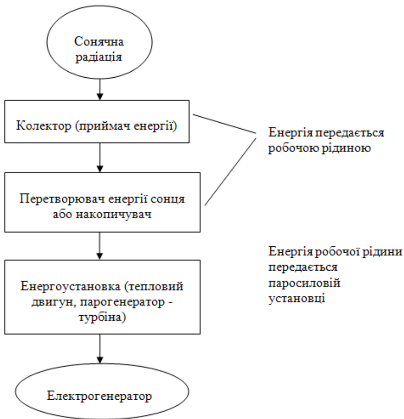
Рис. 1.8. Схема одержання електричної енергії сонячною теплоелектростанцією
