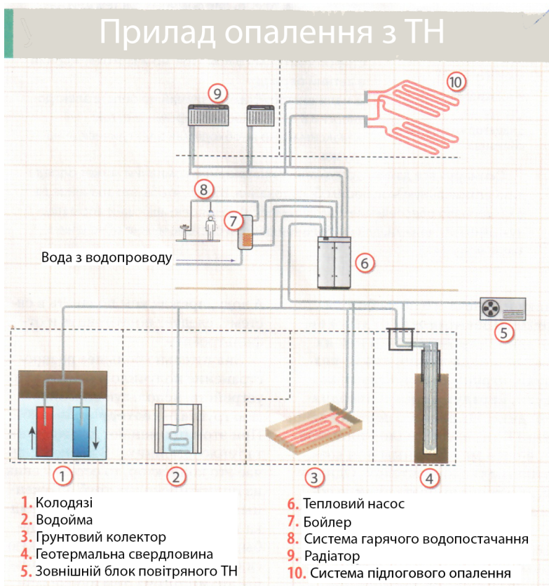
Рис. 4.21. Загальна схема опалення з тепловим насосом
