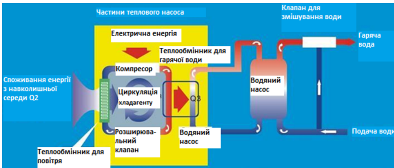
Рис. 4.13. Складові частини теплового насоса водного типу
