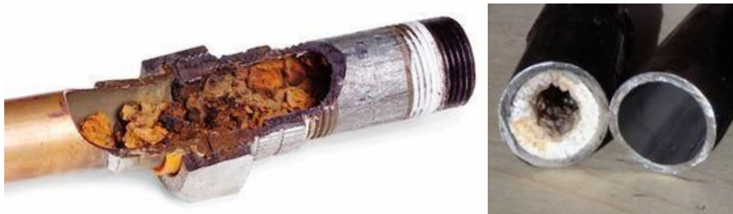
Рис. 1. Продукти корозії трубопроводів і накип.
