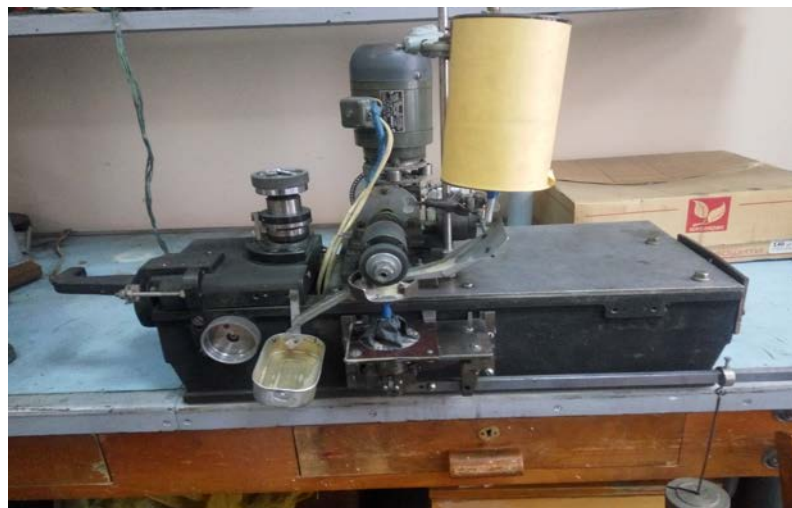
Рис. 2.2. Загальний вид машини тертя для випробування на абразивну зносостійкість в умовах не жорстко закріплених частинок [130, 131]
