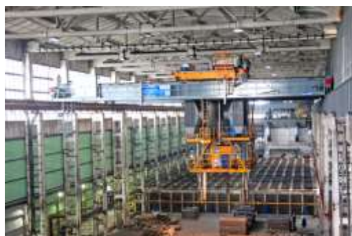
Рисунок 1. Печи продольной графитации и передвижная пневмоустановка.
