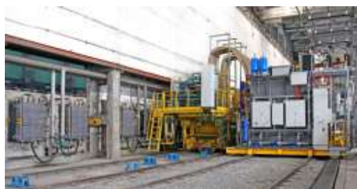
Рисунок 2. Модуль ввода электрической мощности и поджима заготовок.
