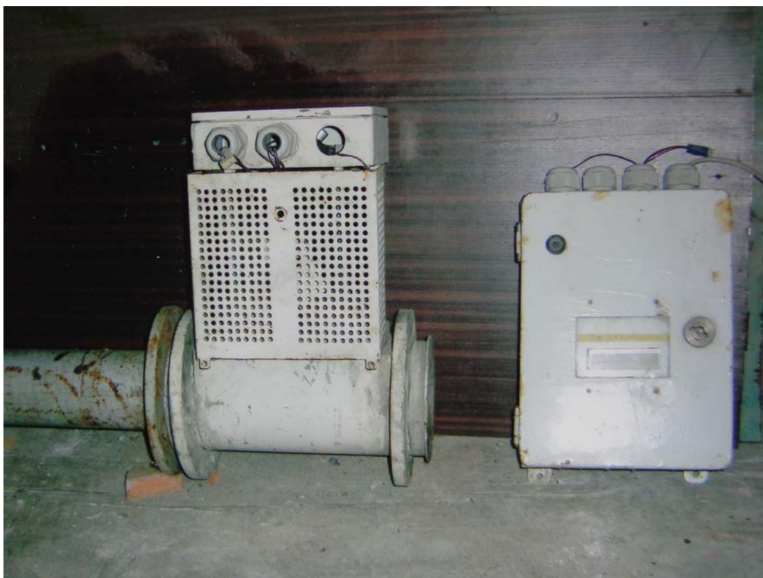
Рисунок 5.9. Зовнішній вигляд дослідної моделі лічильника СВ змінного перепаду тиску з трубою Вентурі D_y = 50 мм
