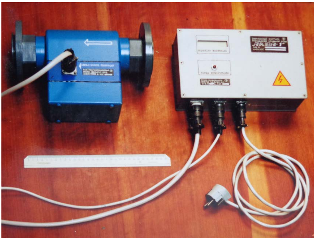
Рисунок 5.8. Зовнішній вигляд дослідної моделі лічильника СВ змінного перепаду тиску з трубою Вентурі D_y = 50 мм
