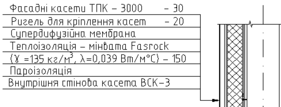
Рис.5.6. Приклад шарів огорожувальної конструкції
