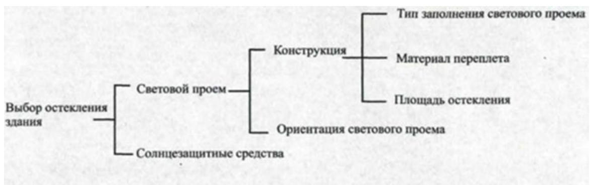
Рис.2.50. Принцип вибору засклення будівлі
