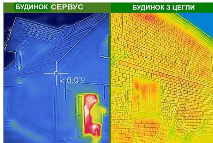
Рис.1.4. Показники тепловтрат конструкції стін в будинку Сервус і будинку з цегли
