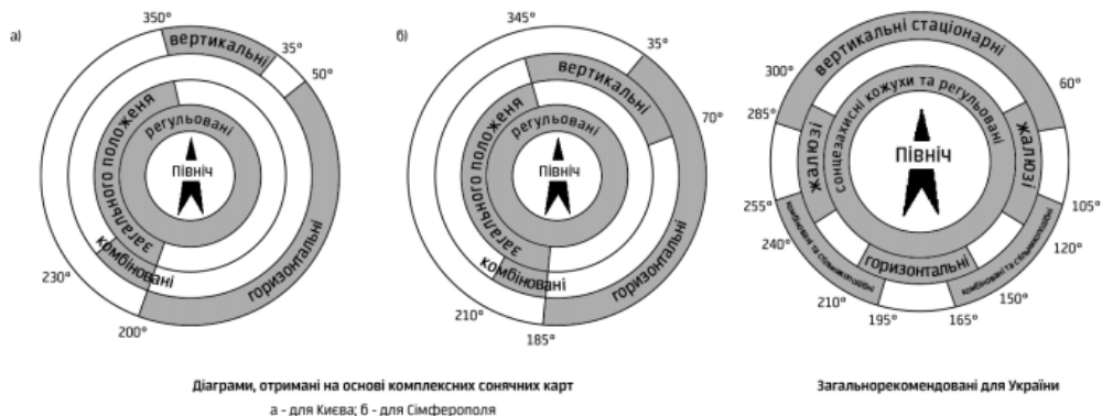
Рис.1.10. Вибір раціонального виду сонцезахисних пристроїв в залежності від орієнтації фасаду
