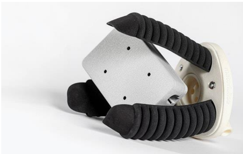
Рис. 1.3.2. Маніпулятор виготовлений з гнучкого філаменту [23]
