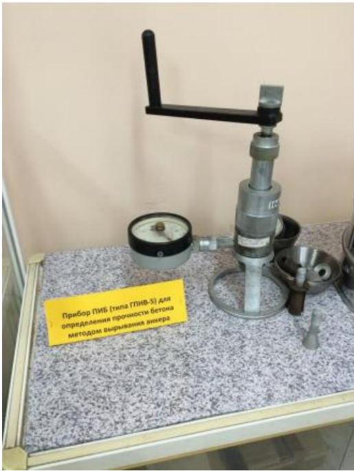
Рис. 2.14. Прилад марки ГПНВ-5 для визначення міцності бетону методом відриву анкера.
