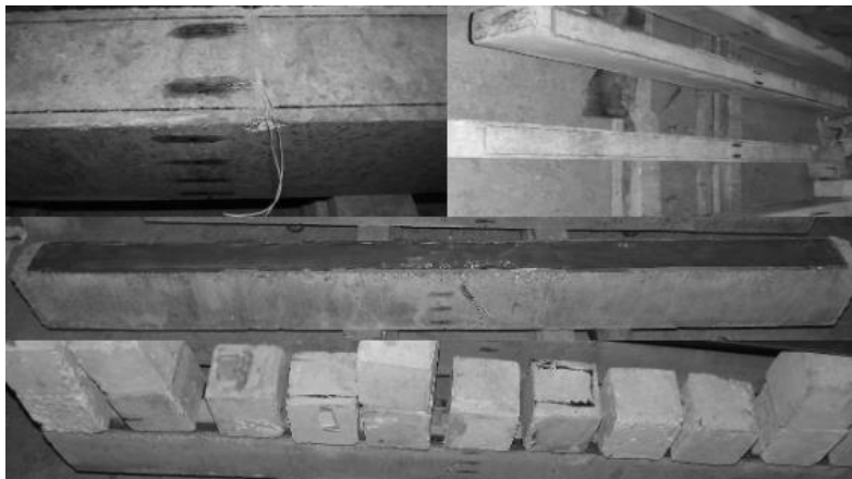
Рис.2.5 Технологія клейового з'єднання зразка
