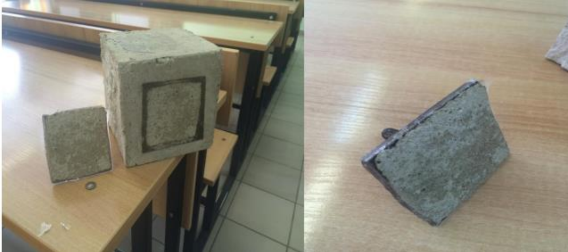
Рис. 2.1.5 Характер когезійного руйнування з'єднання сталь-клей-бетон на акрилових модифікованих клеях
