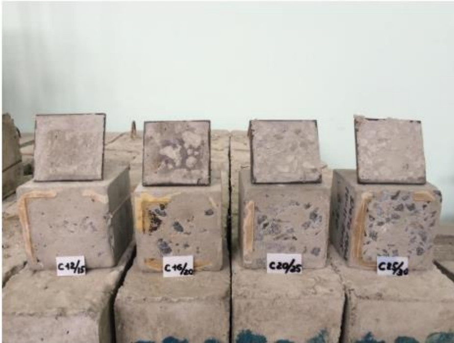
Рис. 2.19 Характер руйнування клейових кріплень в залежності від класу бетону (зліва направо класи бетону: C12/15, C16/20, C20/25, C25/30).
