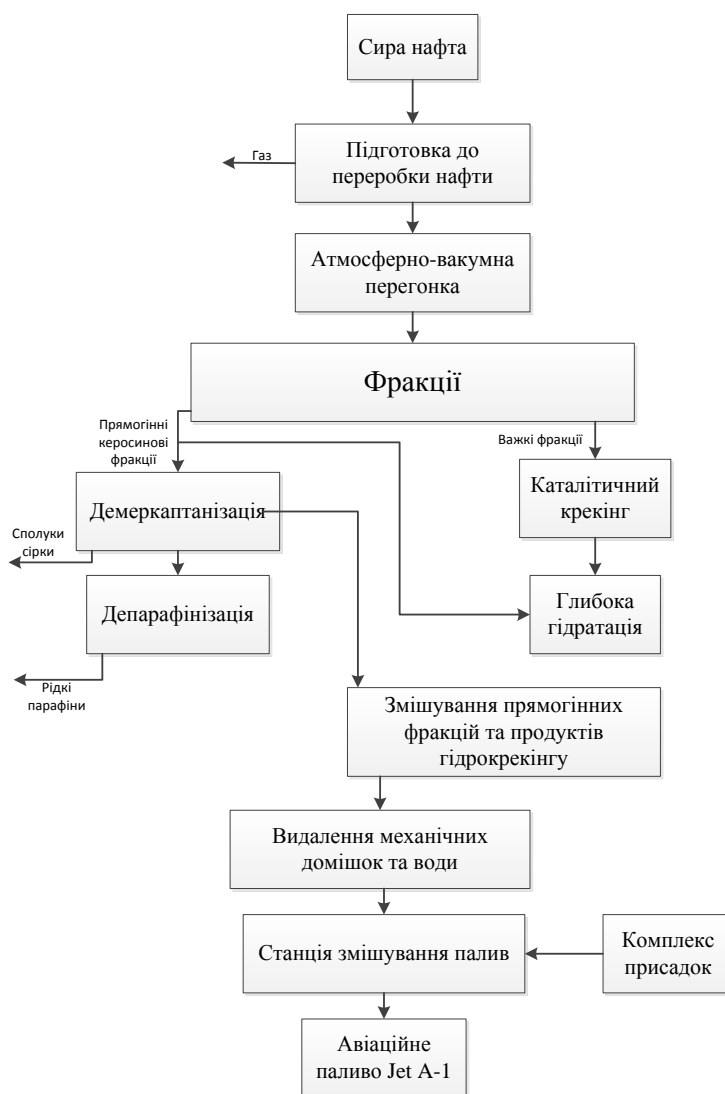
Рис. 1.3. Технологічна схема виробництва авіаційного реактивного палива марки Jet A-1
