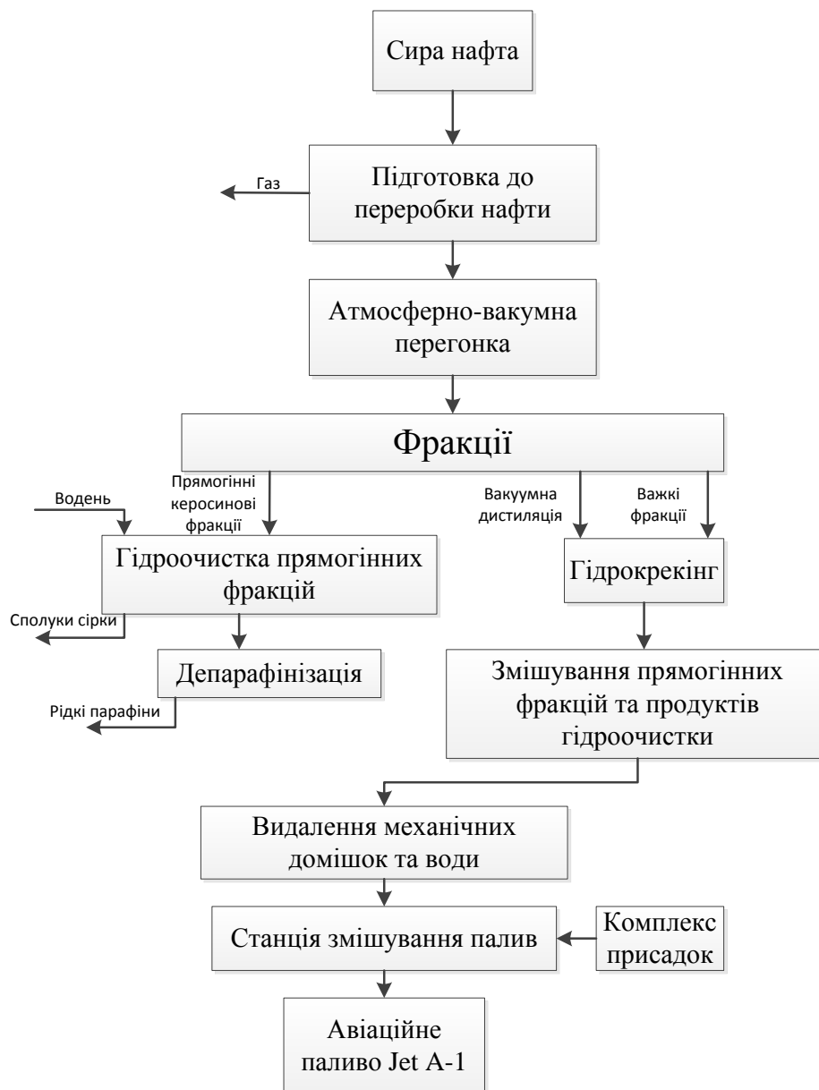
Рис. 1.5. Технологічна схема виробництва авіапалив сорту —RT
