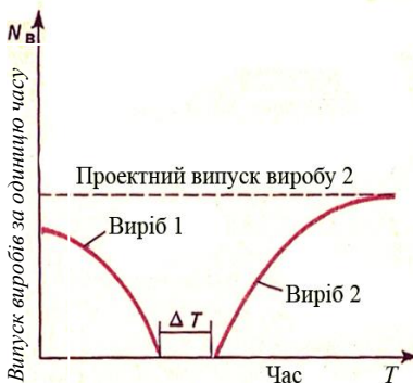
Рис. 1.2. Перервно-послідовний метод переходу на випуск нового виробу
