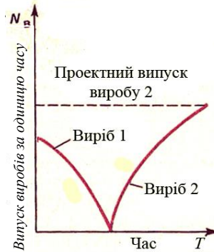
Рис. 1.3. Безперервно-послідовний метод переходу на випуск нового виробу
