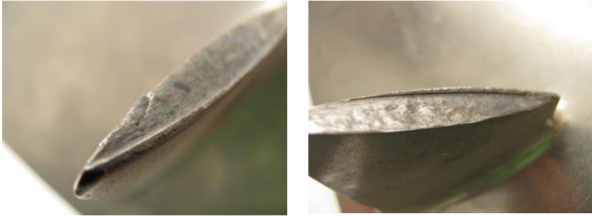
Рис. 5.22. Топографія зношеної поверхні антивібраційної полиці робочої лопатки ГТД із титанового сплаву
