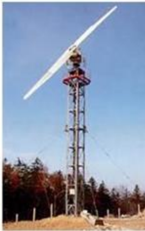
а) однолопатева; б) дволопатева; в) трилопатева; Рисунок. 3.4. - ВЕУ з горизонтальною віссю обертання
