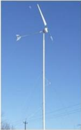
а) однолопатева; б) дволопатева; в) трилопатева; Рисунок. 3.4. - ВЕУ з горизонтальною віссю обертання
