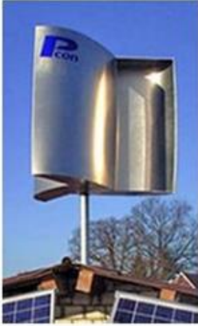
а) з ротором Савоніуса; б) з ротором Масгрува; в) з ротором Дар'є; Рисунок. 3.3. - ВЕУ з вертикальною віссю обертання
