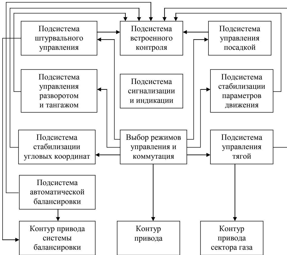
Рис. 1. Структурно-функциональная схема автоматизированной системы управления летательным аппаратом
