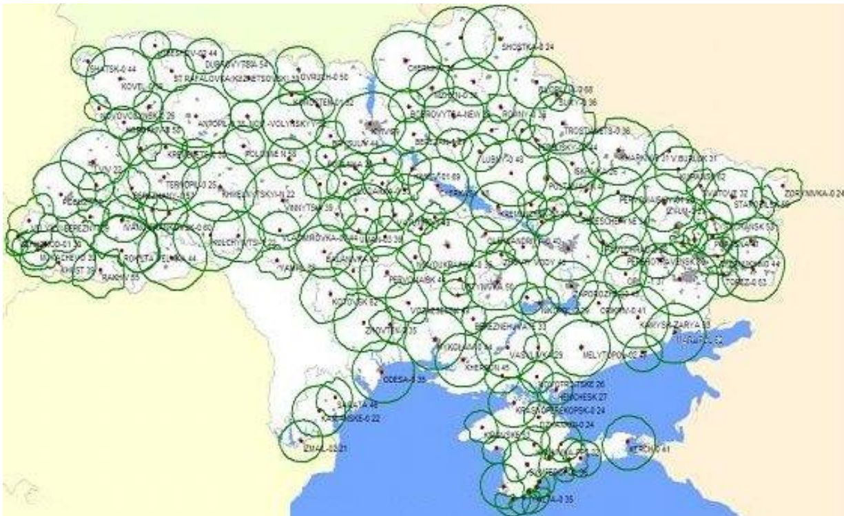
Рис. 2.3. Карта покриття ефірним цифровим мовленням стандарту DVB-T2
