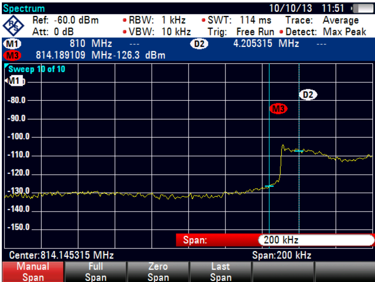
Рис. 2.18. Лівий схил спектра радіовипромінювання з центральною частотою 818 МГц з RBW = 1 кГц та VBW = 10 кГц.
