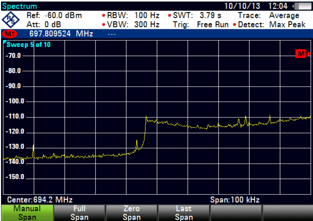
Рис. 2.19. Лівий схил спектра радіовипромінювання з центральною частотою 698 МГц з RBW = 100 Гц та VBW = 300 Гц.
