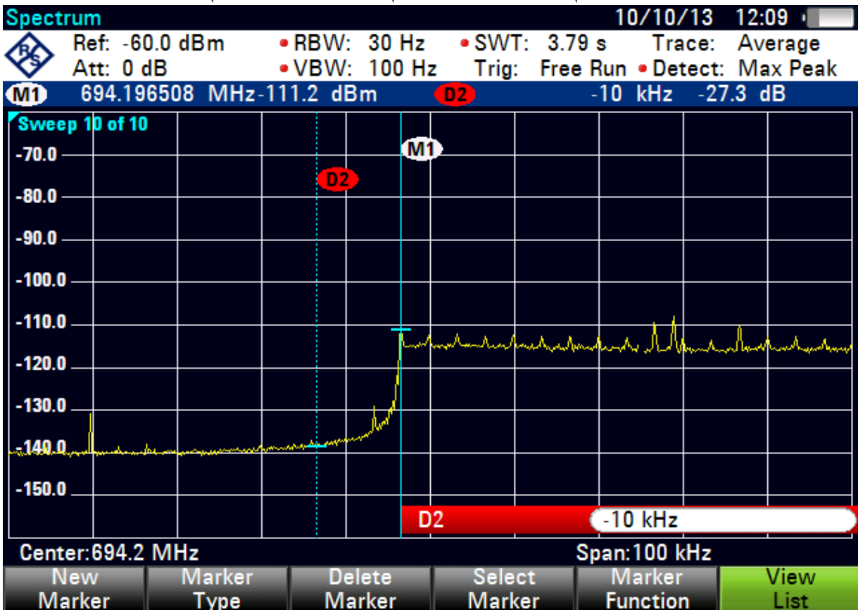
Рис. 2.20. Лівий схил спектра радіовипромінювання з центральною частотою 698 МГц з RBW = 30 Гц та VBW = 100 Гц.
