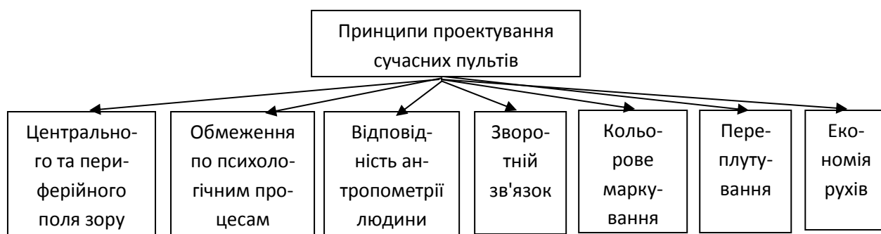
Рис. 4.18. Принципи проектування сучасних пультів
