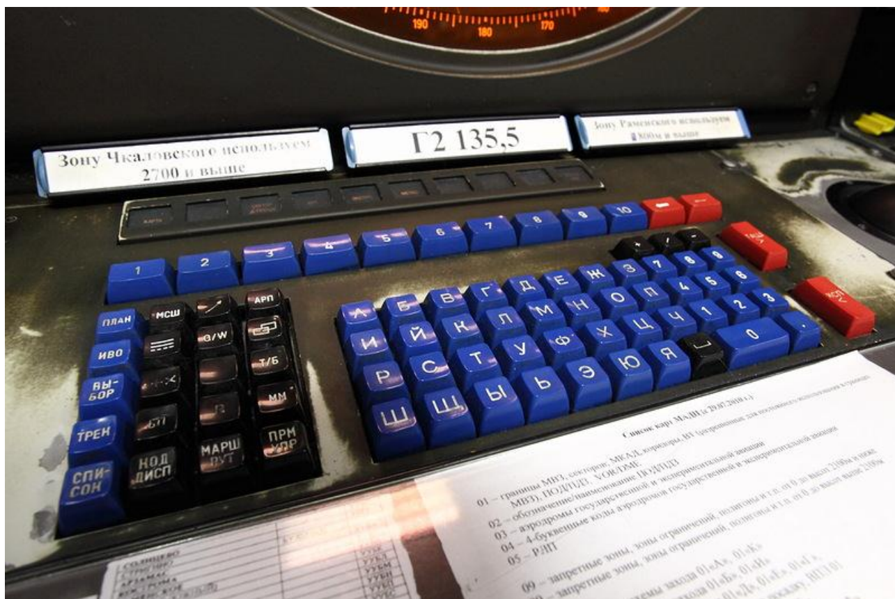
Рис 4.19 Клавіатура на робочому місці диспетчера радіолокаційного керування. Московський центр керування повітряним рухом
