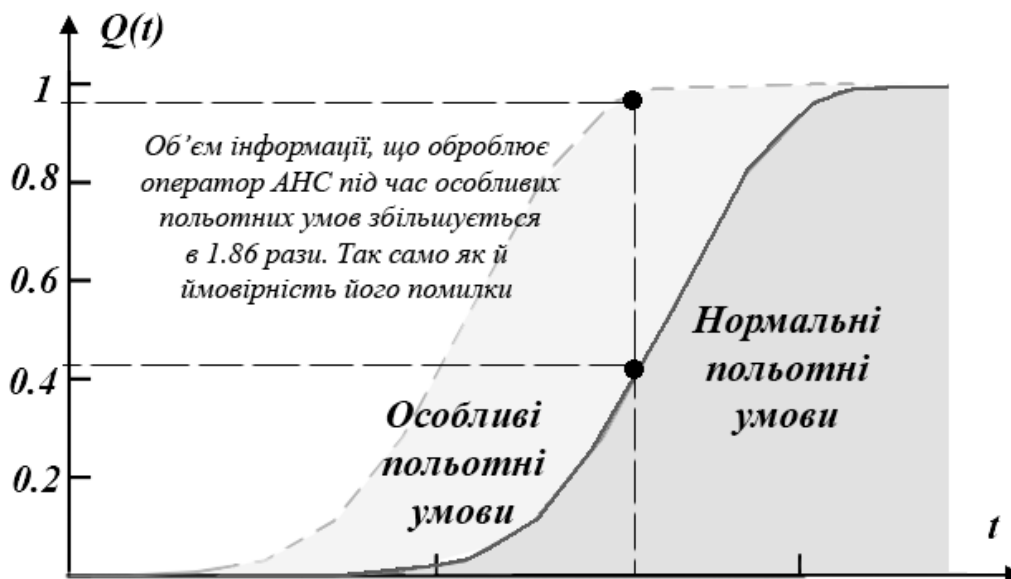
Рис. 3.6. Збільшення обсягу інформації в аварійних режимах роботи оператора АНС
