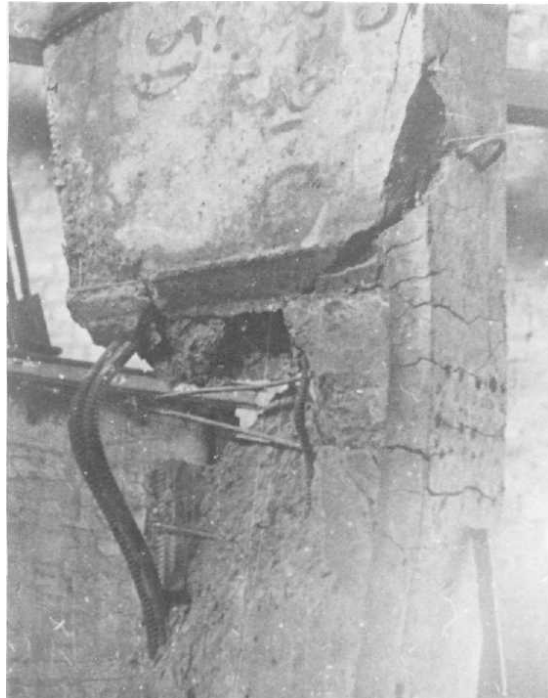
Рис. 3.15. Таврова стійка піврами після випробувань
