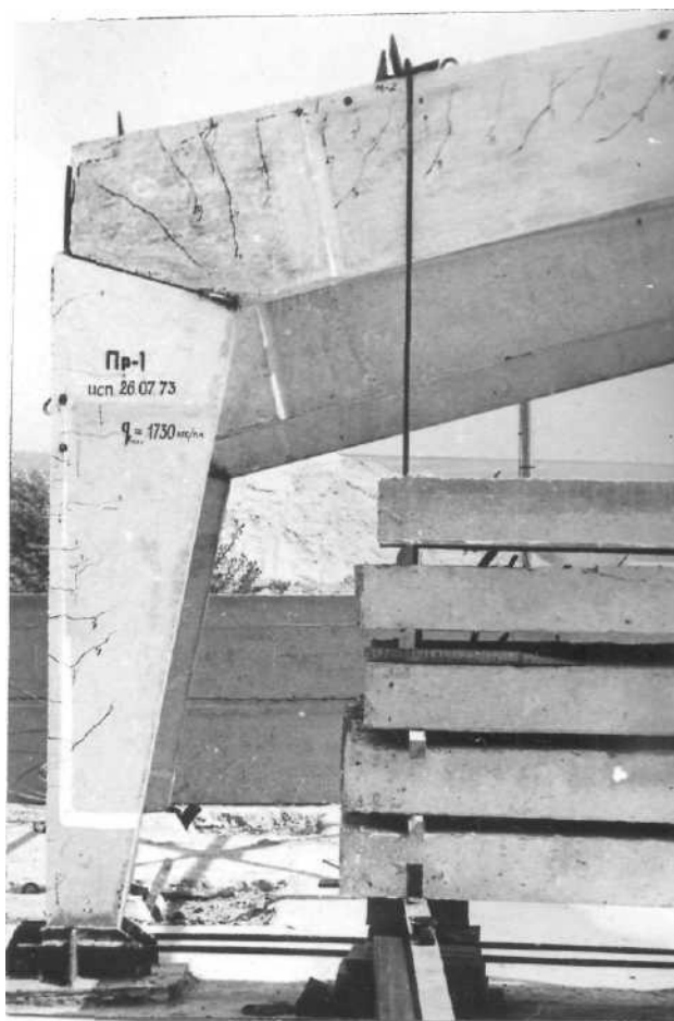
Рис. 3.18. Права піврама РЖС-21-1350 після випробувань
