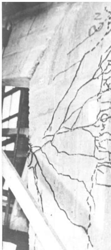
Рис. 3.47. Загальний вид стійки рами після випробувань
