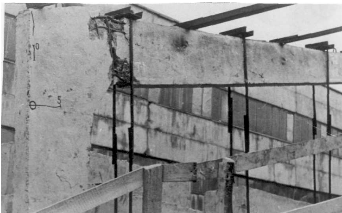
Рис. 3.35. Суцільна піврама після випробувань
