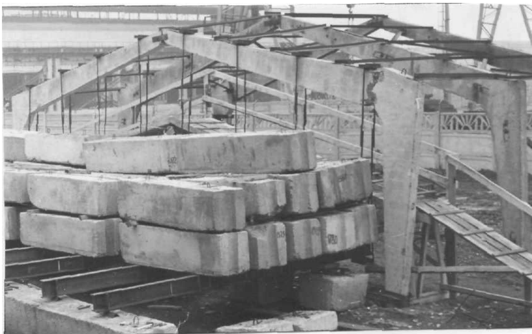
Рис. 3.34. Рама прольотом 12 м після випробувань
