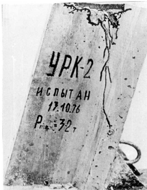
Рис.3.42. Випробуваний зразок конкового вузла піврами
