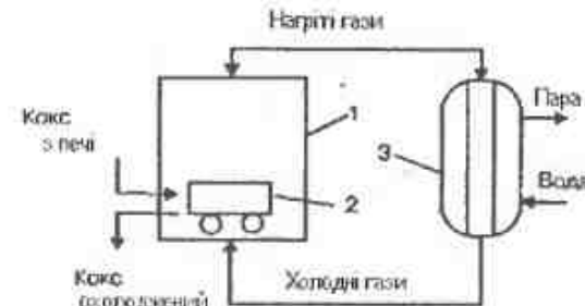
Рис. 6.26. Схема сухого газіння: 1 - газильна камера; 2 — вагон з коксом; 3 — котел-утилізатор
