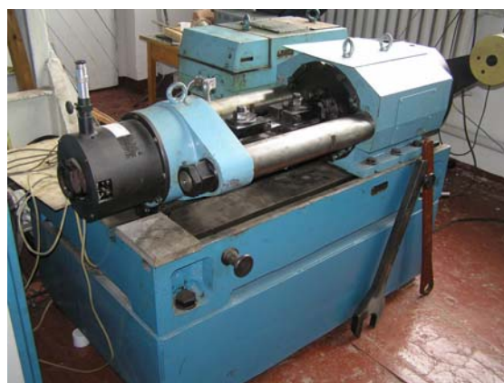
Рисунок 2.82 – Установка для проведения усталостных испытаний УММ-02
