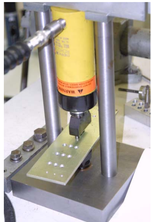
Рисунок 5.11 – Обработка зоны функциональных отверстий методом барьерного обжатия
