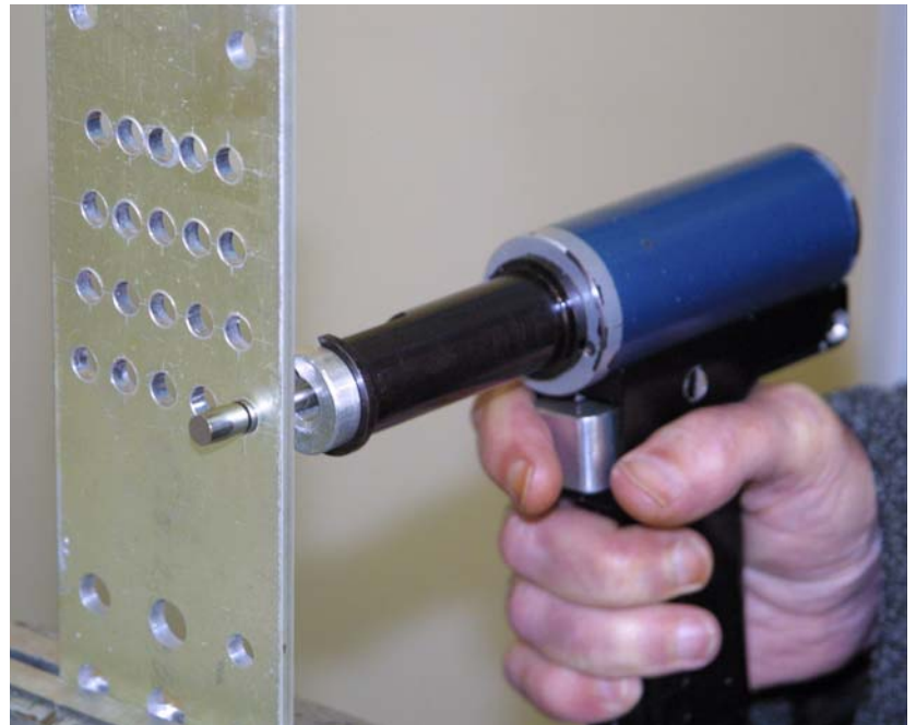
Рисунок 5.7 – Дорнование стенок функциональных отверстий
