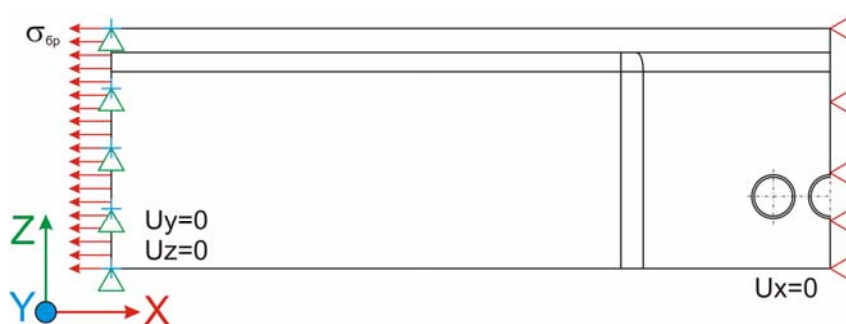
Рисунок 3.29 – Расчетные схема стрингера с тремя отверстиями \varnothing 8 мм
