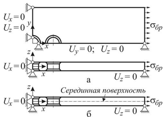
Рисунок 3.8 – Расчетная схема полосы с тремя отверстиями, обрабатываемой методом дорнования: а – этап дорнования и извлечения дорнов; б – этап приложения растягивающих нагрузок, соответствующих заданным номинальным напряжениям
