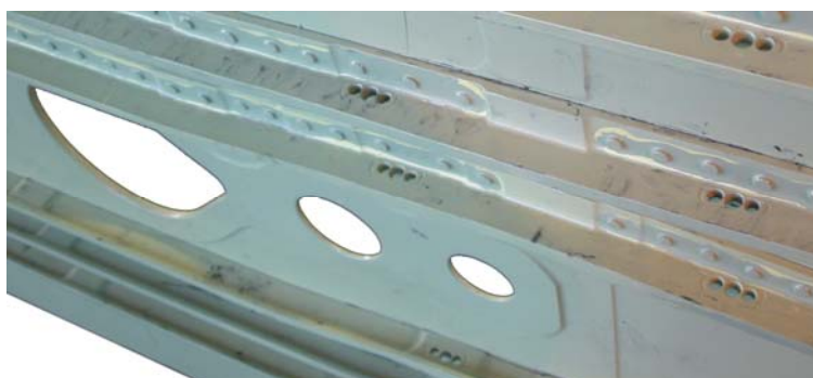
Рисунок 1.7 – Фрагмент растянутой панели крыла с вырезом под установку блока топливных насосов и отверстиями для перетекания топлива
