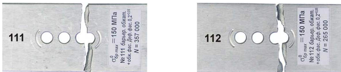
Рисунок 4.10 – Характер усталостного разрушения образцов полос с тремя отверстиями, обработанных в зоне отверстий методом барьерного обжатия в виде лунок сегментной конфигурации и обжатием фасок, из пресованного профиля (материал Д16Т)
