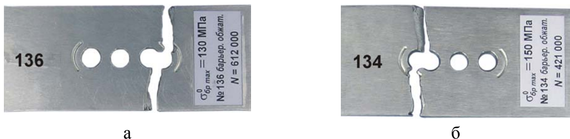
Рисунок 4.9 – Характер усталостного разрушения образцов полос с тремя отверстиями, обработанных в зоне отверстий методом барьерного обжатия в виде лунок сегментной конфигурации, из прессованного профиля (материал Д16Т) на уровне нагружения \sigma_{бр\ min} = 0 МПа, \sigma_{бр\ max} = 130 МПа (а),
