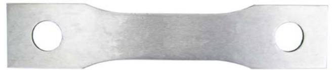
Рисунок 4.5 – Заготовка для изготовления образцов полос с отверстиями
