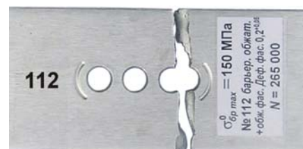
Рисунок 21 – Характер втомного руйнування зразків смуг із трьома отворами
