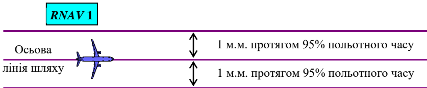
Рис 4.6. Вимоги до точності витримування лінії шляху під час використання RNAV
