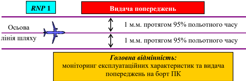
Рис 4.5. Функція автоматичного слідкування за характеристиками та попередження екіпажу
