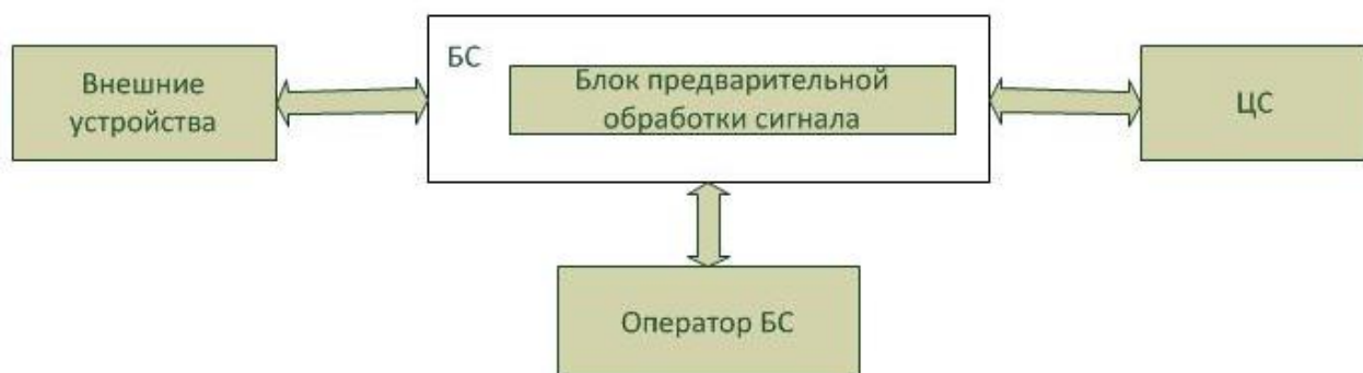
Рис. 4.2. Схема информационных потоков в боковых станциях комплекса
