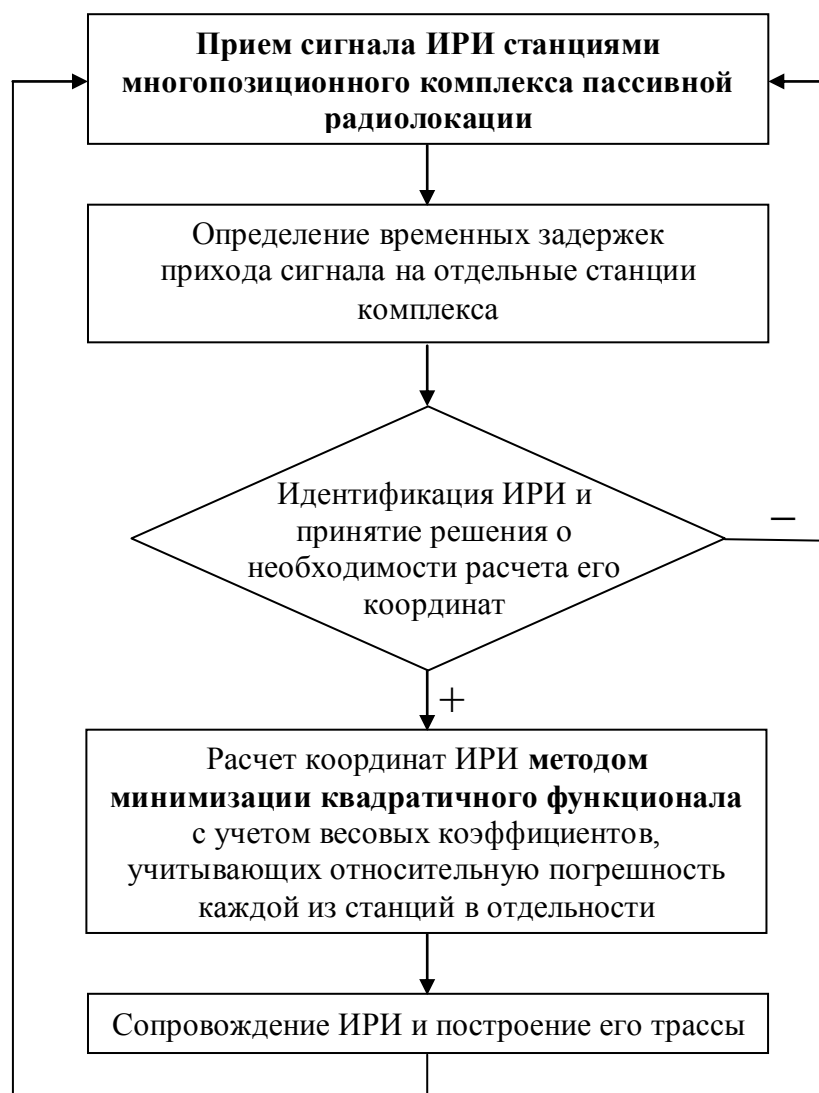
Рисунок 4.9. Блок-схема определения координат ИРИ системой пассивного радиомониторинга при помощи экстремальной постановки РДМ
