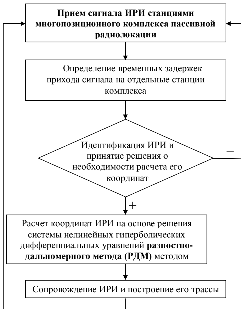
Рис. 4.8. Блок-схема определения координат ИРИ системой пассивного радиомониторинга на основе классического РДМ
