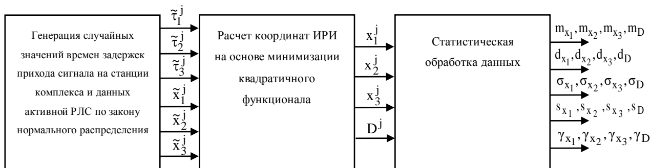
Рисунок 3.7 Функциональная схема статистического моделирования вычисления координат ИРИ методом Монте-Карло
