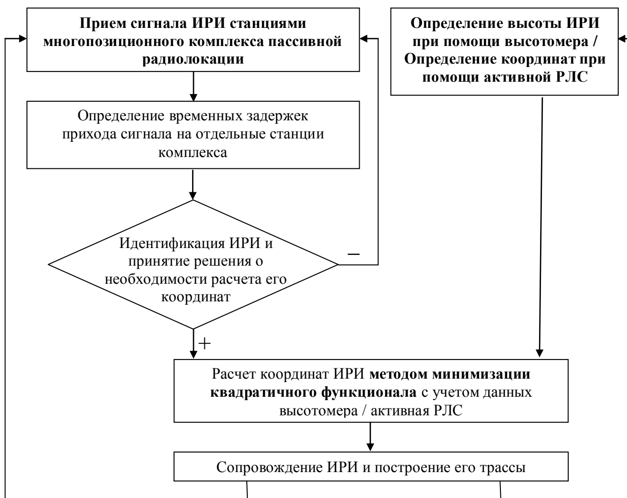
Рис. 4.10. Блок-схема определения координат ИРИ системой пассивно-активного радиомониторинга на основе экстремальной постановки РДМ
