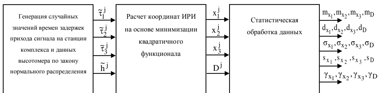
Рис. 3.2. Функциональная схема статистического моделирования вычисления координат ИРИ методом Монте-Карло
