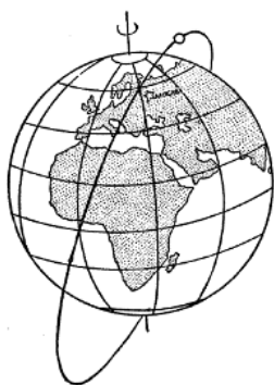
Рис. 1.52. Схема орбіти першого радянського штучного супутника Землі
