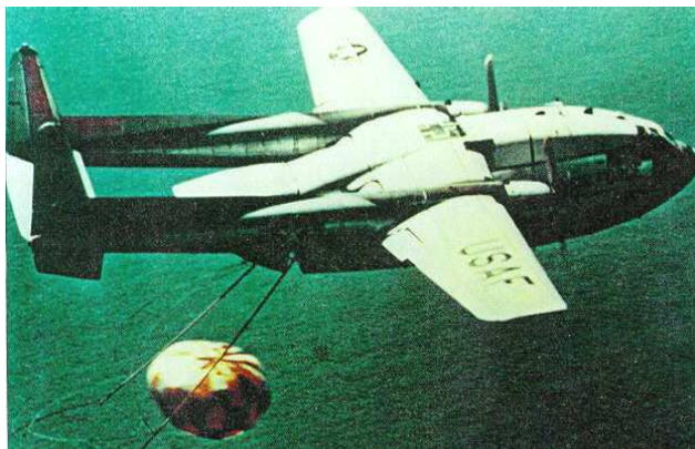
Рис. 2.18. Перехоплення літаком С-119 контейнера з відзнятою плівкою з супутника "CORONA"
