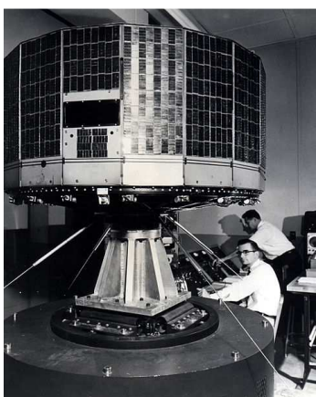
Рис. 2.23. “TIROS-1” (Television InfraRed Observation Satellite) – перший у світі метеорологічний супутник
