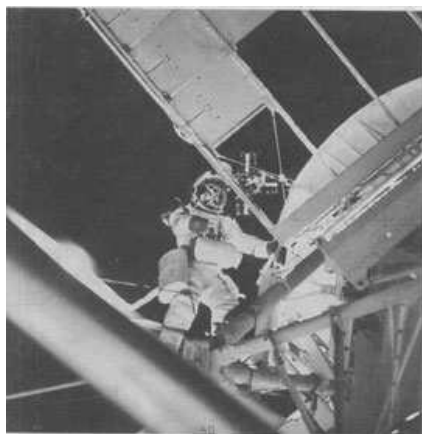
Рис. 3.47. Астронавт Герріот О. під час другого виходу у відкритий космос 24 серпня 1973 р. замінює касети з фотоплівкою в комплекті астрономічних приладів АТМ. Фото NASA
