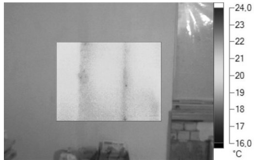
Рис. 7.3. Термографування внутрішньої поверхні базових і виявлених аномальних ділянок
