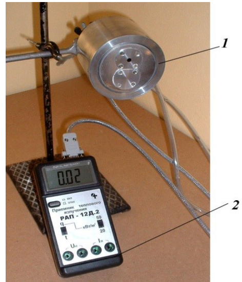
Рис. 5.16. Приймач теплового випромінювання РАП-12Д: 1 – приймальний пристрій; 2 – вторинний цифровий пристрій
