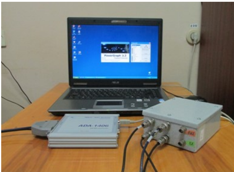
Рис. 4.2. Мобільна система збирання, реєстрування та опрацювання акустичних сигналів
