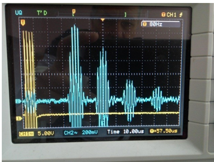
Рис. 4.25. Осцилограма сигналу на виході приймаючого МСС
