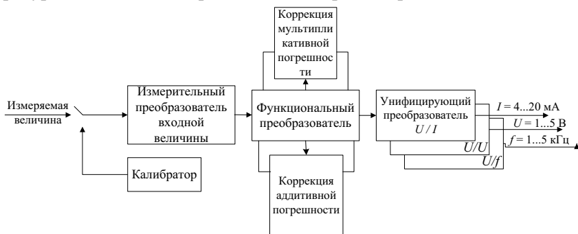
Рис. 8.8. Структурная схема АИ с ручной коррекцией погрешности
