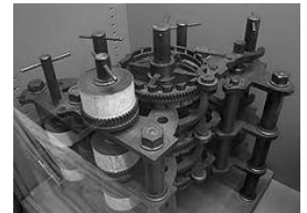
Модель вычислительной части разностной машины Чарльза Бэббиджа
