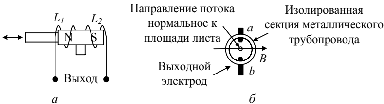
Рис. 7.7. Электромагнитные датчики: а – линейный преобразователь скорости; б – преобразователь скорости потока жидкости
