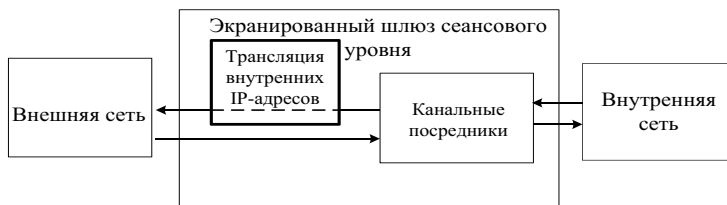
Рис. 14.38. Схема функционирования шлюза сеансового уровня
