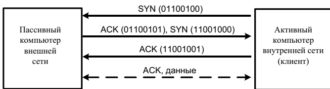
Рис. 14.37. Схема квитирования связи по протоколу TCP
