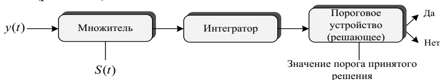
Рис. 11.23. Функциональная схема устройства для выявления сигнала корреляционным методом
