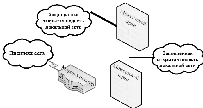
Рис. 14.44. Схема с разделительной защитой закрытой и открытой подсетей на основе двух брандмауэров с двумя сетевыми интерфейсами
