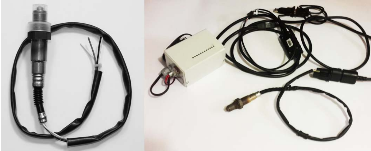
Рис. 2. Система регулирования процесса горения (а – широкополосный кислородный зонд, б – главный узел)
