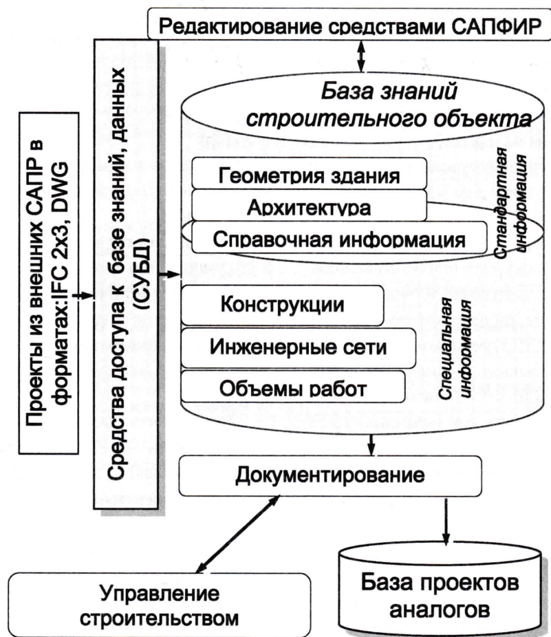
Рис. 2. Функциональная структура базы знаний строительного объекта
