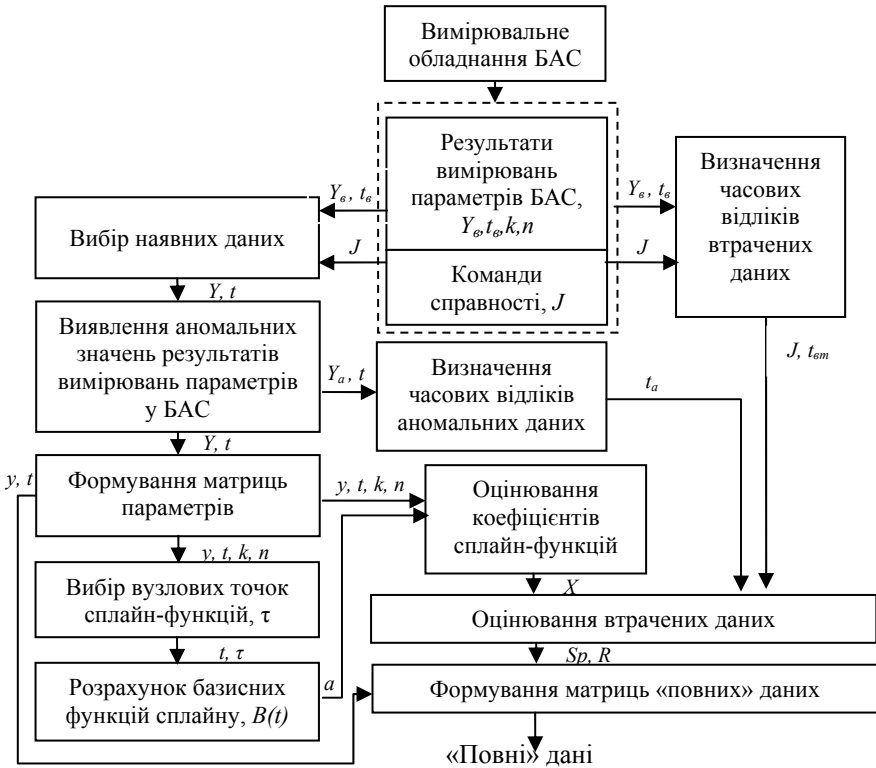
Рис. 1. Структурна схема розробленого методу багатопараметричного відновлення польотних даних
