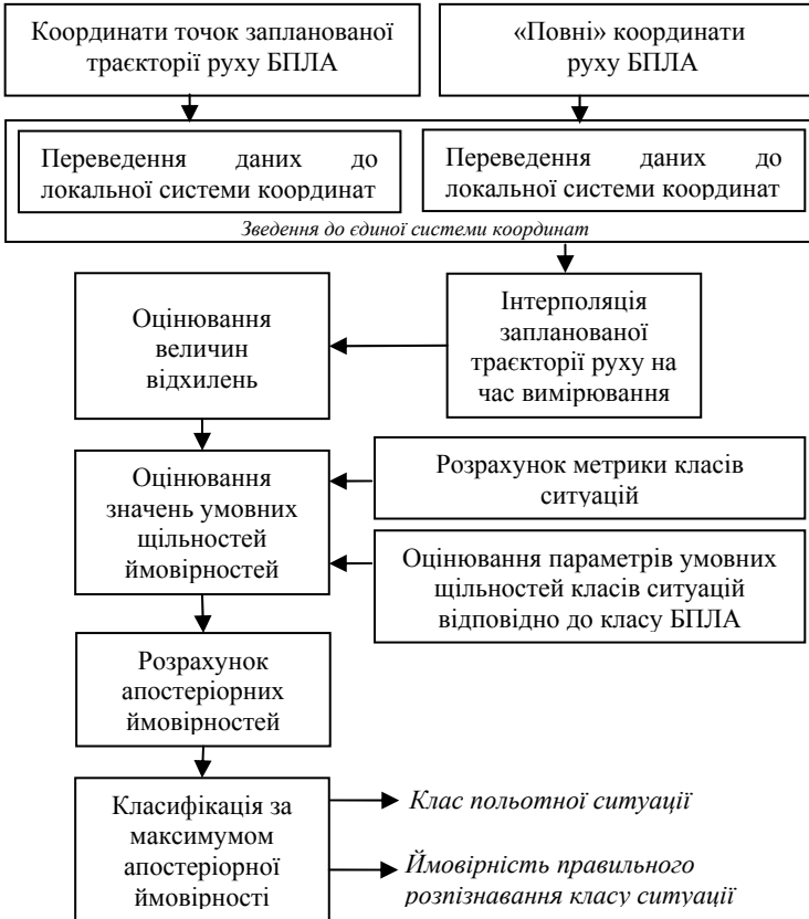
Рис. 3. Структурна схема удосконаленого методу багатоальтернативної класифікації польотних ситуацій БПЛА
