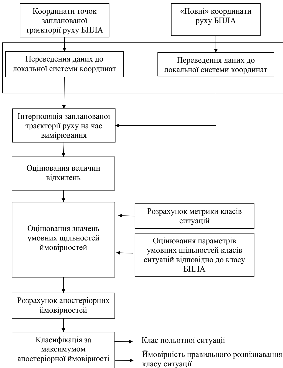
Рис. 3.10. Структурна схема удосконаленого методу багатоальтернативної класифікації польотних ситуацій БПЛА
