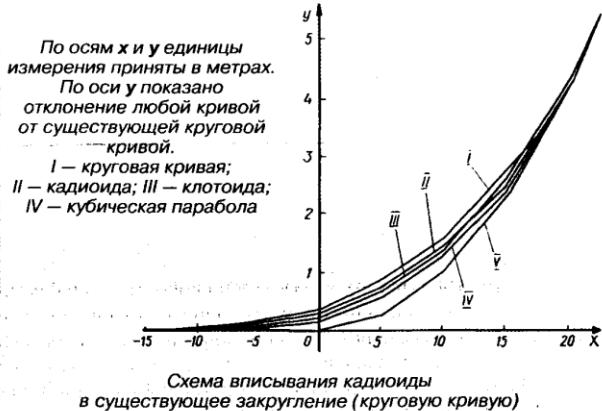
Гладкое сопряжение отдельных участков графика центробежного ускорения со значениями  $a=0$  и  $a=v^2/R=\text{const}$  на концах этих участков может осуществлять только такая переходная кривая, при движении по которой график ускорения имеет S-образную форму с двумя экстремумами на концах.
