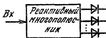
Рис. 17.5. Схема многопозиционного ОФВ
