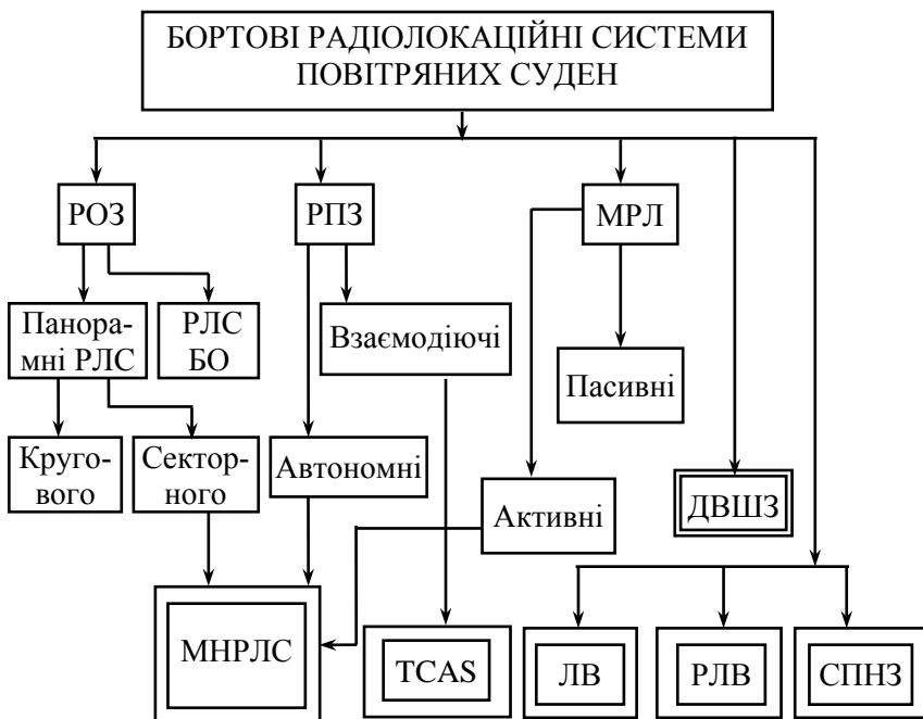
Рис. 1.16. Класифікація БРЛС за призначенням з виділенням ряду інших ознак
