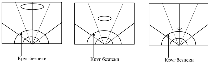
Рис. 3.13. Зменшення засвічення від гори в міру наближення до неї
