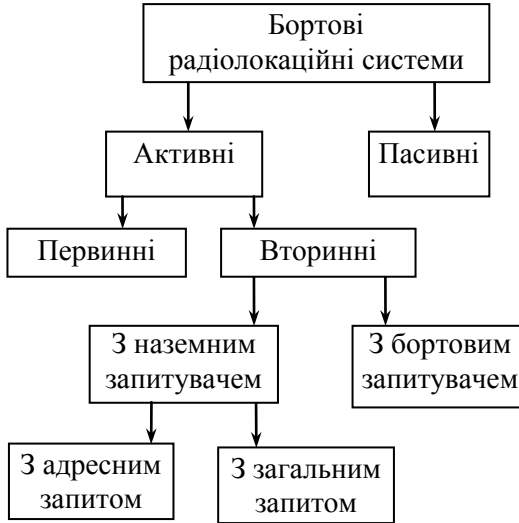
Рис. 1.1. Класифікація БРЛС за принципом взаємодії з ціллю
