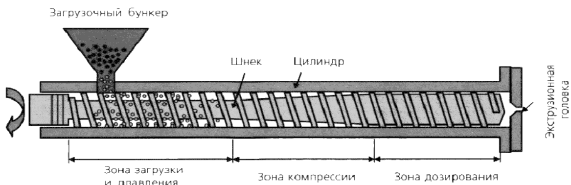
Рис.1. Схема екструдера одношнекового
