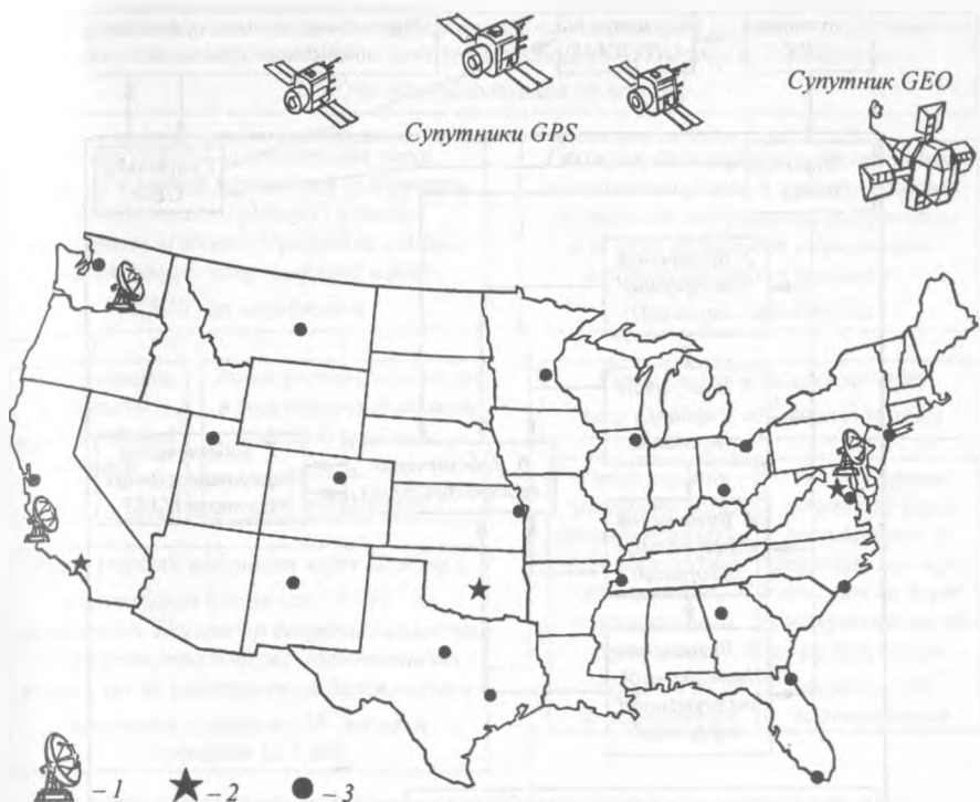
Рис. 5.2. Структура широкозонної системи WAAS: 1 – головні станції; 2 – контрольні опорні станції; 3 – наземні станції передавання даних.
