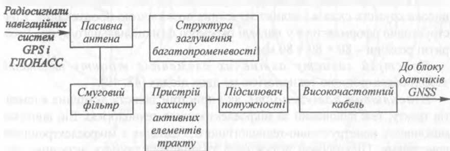
Рис. 3.20. Структурна схема антенно-фідерного пристрою.
