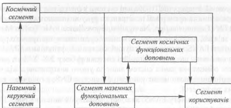
Рис. 1.1. Блок-схема супутникової радіонавігаційної системи.
