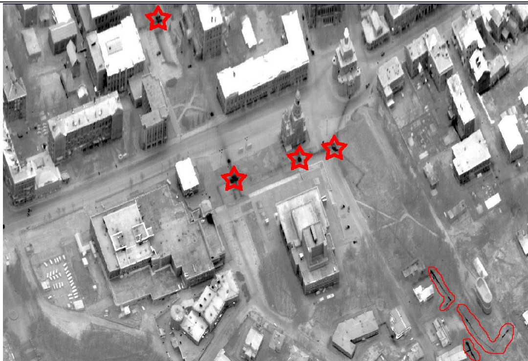
Рис. 3. Снимок жилой территории, полученный в ходе тепловой аэросъемки («звездами» выделены места утечек теплоносителя; линиями обведены контуры трубопровода с нарушенной теплоизоляцией)
