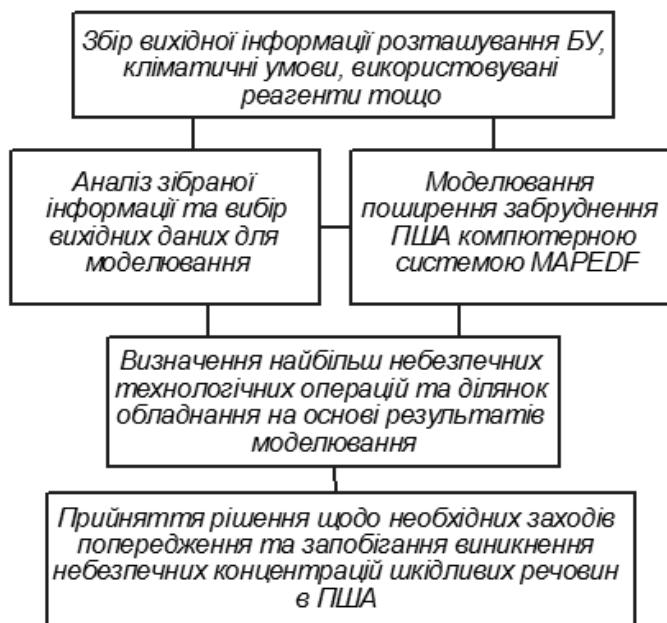
Рис. 4.27. Структурна схема системи запобігання забруднення ПША під час буріння нафтогазових свердловин
