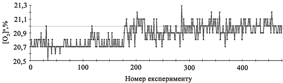
Рис. 3.6. Зміна об'ємної концентрації кисню в повітрі, виміряна газоаналізатором ОКСІ-5М протягом того ж періоду
