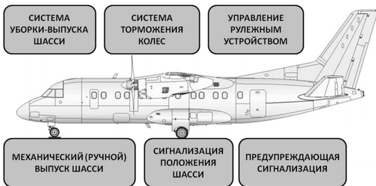
Рис.5.3. Взаимодействие шасси с системами самолета
