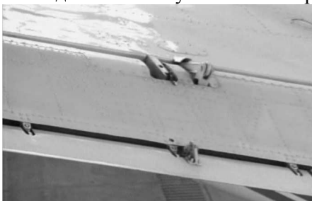
Рис. 8.22. Крепление триммера-сервокомпенсатора к рулю высоты
